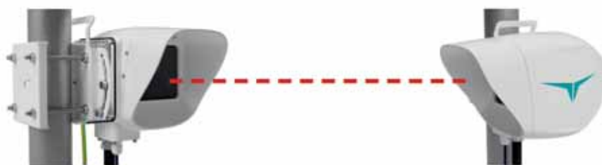
Abbildung 1: Sende-/Empfangeinheit. Das Set aus zwei Einheiten fungiert als reine Ethernet-Bridge ohne IP-Paketfilterung. I1=1550nm (Datenübertragung) I2=810nm (Tracking und Justage Referenzlaser)
