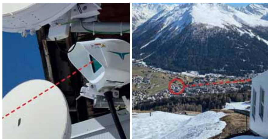
Abbildung 4 und 5: FSO bietet sich für eine Vielzahl von Anwendungsmöglichkeiten an, beispielsweise für Nahbereichs-Interlinks bei verteilten Zugangspunkten, wie hier bei einer Bergbahn
